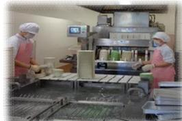
洗浄機で洗浄後、熱風で消毒をします。
