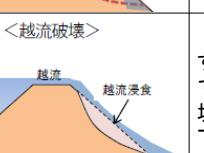
豪雨により堤体を越えて流れ出ると、法面を流下することによって、破壊する場合がある。また、堤体内の水圧も上昇し、強度が低下して破壊する場合がある。
