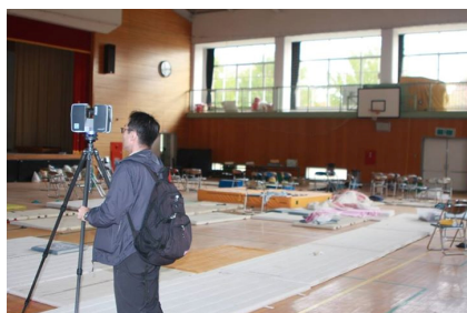
立体データ測量中 (苅野小学校体育館)
